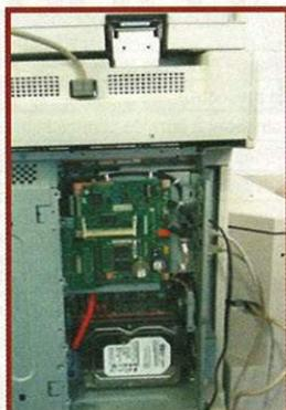
*Fig. 1 : Exemple d'imprimante RICOH démontée. On distingue aisément le disque dur 3.5" et la carte mère.*
